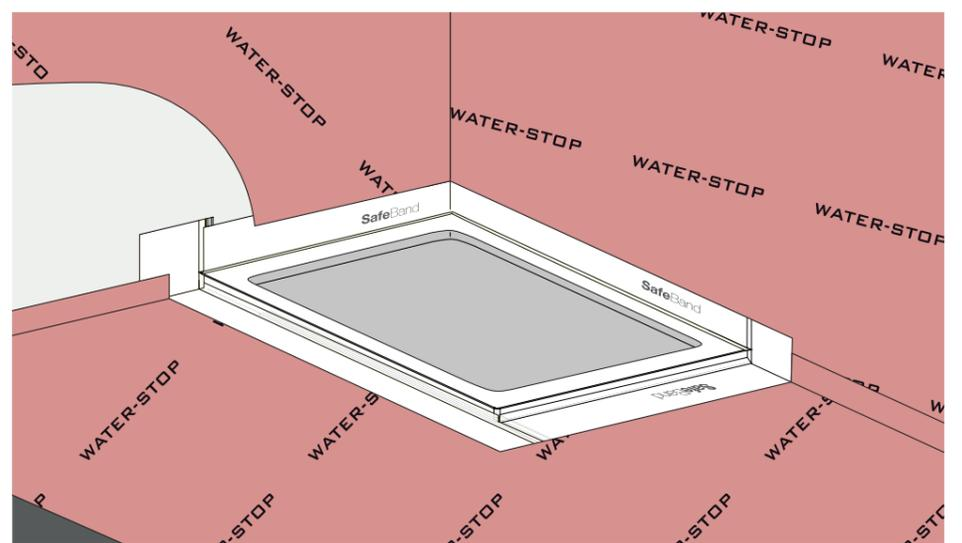
Assim que a base de duche ou banheira estiver instalada na sua posição final, cole a **SafeBand** nas paredes e no chão com cimento cola tipo C2. Instale, se planeado, tela de impermeabilização nos pisos e paredes. A **SafeBand** deve-se sobrepor à tela de impermeabilização tanto piso como nas paredes.
