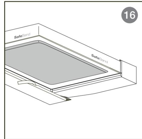
Comece por retirar a proteção da aba estreita (ver imagem 15) e cole-a na borda lateral e na faixa da banda do outro lado (ver imagem 16). Assim que todas as tiras estiverem coladas, pressione com força com o aplicador por todo o contorno da banda.
