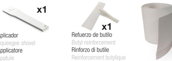
**ES** - La banda de impermeabilización SafeBand puede ser usada en cualquier plato de ducha o bañera ya sea de metal, cerámica, resinas o acrílico. La banda se coloca pegada en los bordes del plato o bañera y se fija a la pared o al suelo con cemento cola conectando con la impermeabilización. Luego se cubrirá con baldosas o azulejos. El resultado será una protección segura e invisible contra las humedades.
